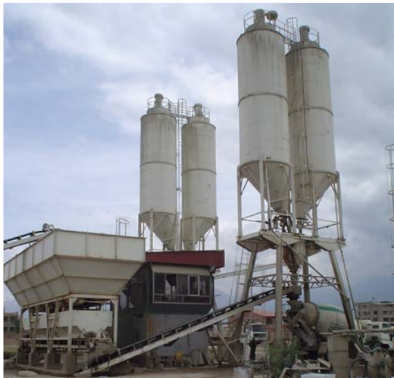
FIGURA 14.3. Fabricación en planta: a la izquierda balanza dosificadora de agregados, arriba der. Silos de alimentación de cemento, abajo der. camión mixer, al centro la caseta de control.
