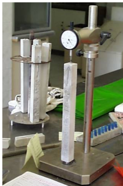
FIGURA 1.12 Medición Briqueita aparato de Autoclave
