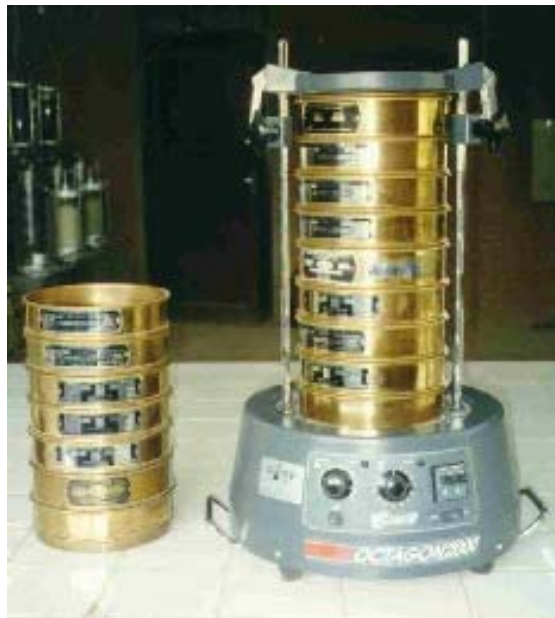
FIGURA 2.5 Serie de Tamices (Laboratorio de Geotecnia, UMSS)
