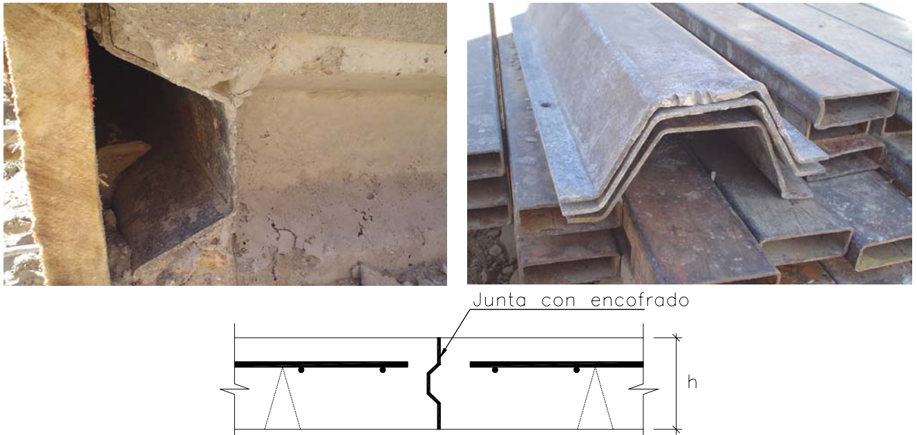
FIGURA 17.19 Junta de hormigonado con Encofrado, en forma de Llave
