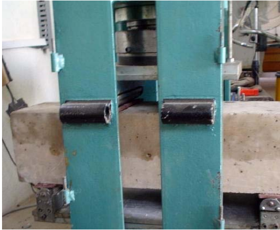
FIGURA 12.9 Ensayo de flexotracción
