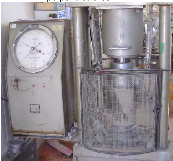
FIGURA 12.7 Ensayo de rotura a compresión. A la derecha se pueden ver 2 probetas luego de la rotura, la de la derecha por falla lateral, y la otra por falla troncocónica
