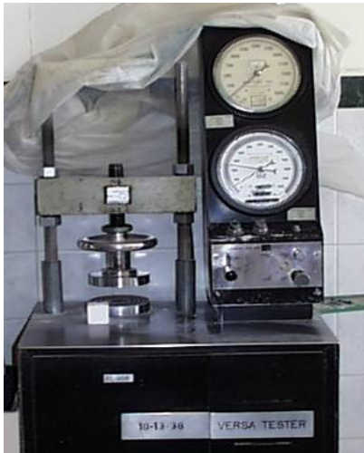
FIGURA 1.9 Máquina para medir la resistencia a la compresión (Laboratorio de la Planta de Cemento COBOCE en Irpa Irpa, Cochabamba)
