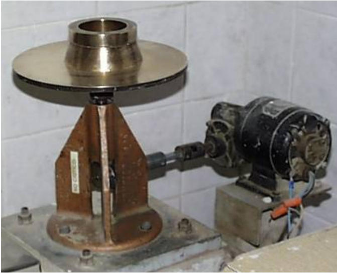
FIGURA 1.13 Mesa de sacudidas. Ensayo de Fluidez (Laboratorio de la Planta de Cemento COBOCE en Irpa Irpa, Cochabamba) Fuente: Propia
