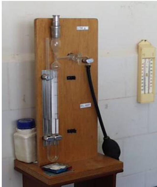
FIGURA 1.6 Permeabilímetro de Blaine (Laboratorio de la Planta de Cemento COBOCE en Irpa Irpa, Cochabamba)
