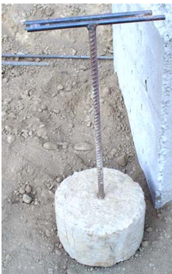
FIGURA 16.1. Pison Manual Distribuidor de la Muyurina - Cochabamba Fuente: Propia
