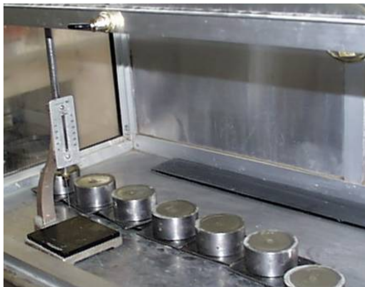
FIGURA 1.2 Ensayo para la determinación del tiempo de fraguado mediante la Aguja de Vicat (Laboratorio de la Planta de Cemento COBOCE en Irpa Irpa, Cochabamba) Fuente: Propia
