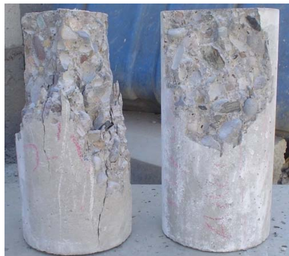
FIGURA 12.7 Ensayo de rotura a compresión. A la derecha se pueden ver 2 probetas luego de la rotura, la de la derecha por falla lateral, y la otra por falla troncocónica
