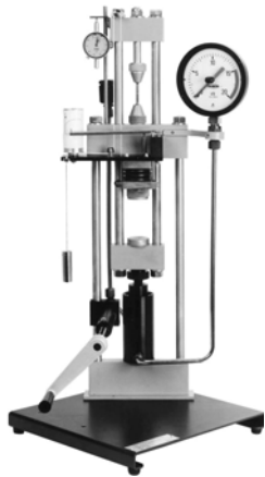
FIGURA 5.16 Aparato Brinell
