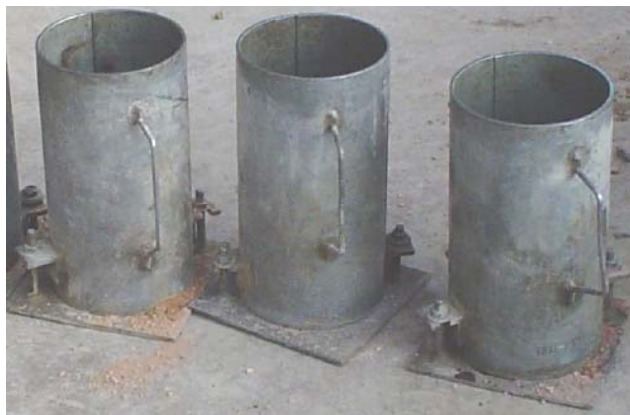
FIGURA 12.5 Probetas para el ensayo de resistencia a compresión y a tracción indirecta (Laboratorio COBOCE HORMIGÓN, Cochabamba) Fuente: Propia
