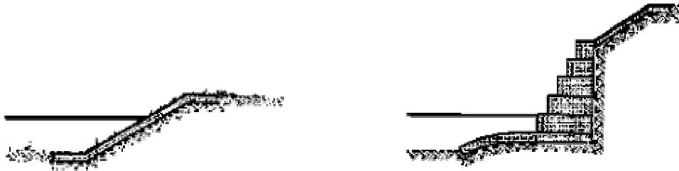
Figura 9.7 Uso de gaviones y colchones en la protección de márgenes
