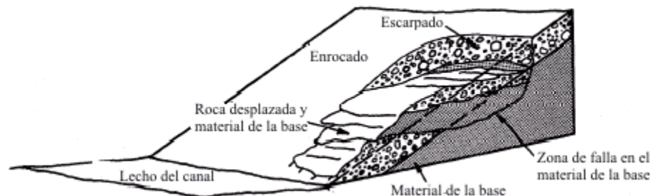
Figura 9.4 Falla por depresiones (Slump)
