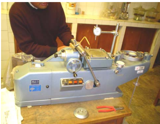
Fig. A.98. Aparato de cizalladura. Lab. ABC. La Paz. Bolivia. Fuente: [Elaboración propia].
