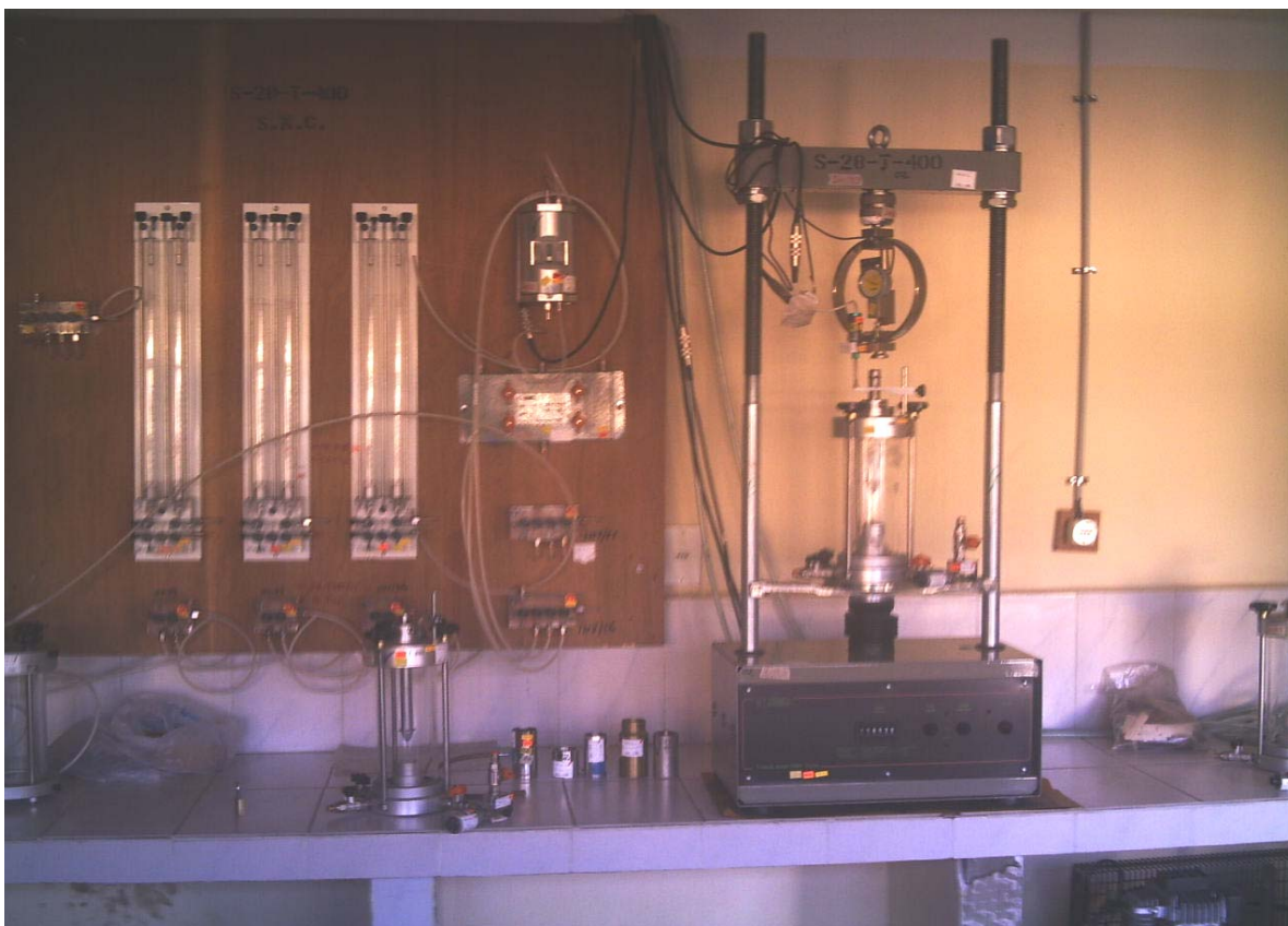
Fig. A.97. Marco computarizado Celda triaxial. / Lab. ABC. La Paz. Bolivia. Fuente: [Elaboración propia].
