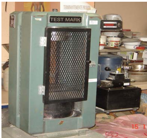
Fig.A.110. Aparato para rotura de cilindros. / Lab. Arquitectura. Fuente: [Elaboración propia].
