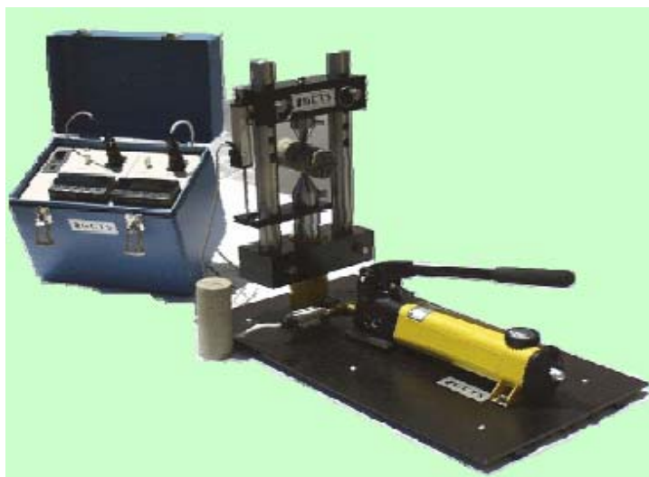
Fig. A.95. Máquina de carga puntual. [9]
