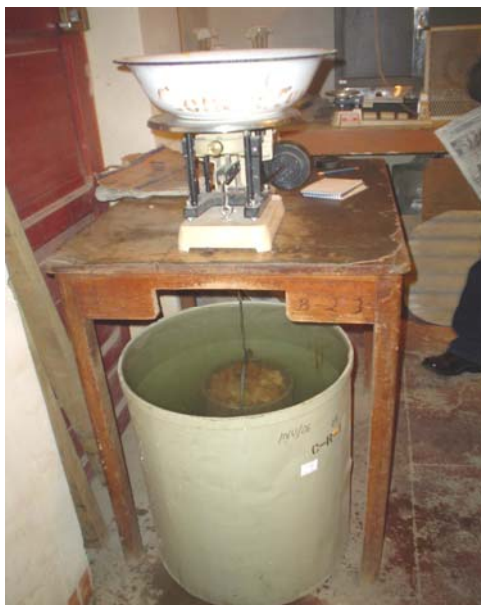
Fig. A.116. Inmersión de los agregados. / Lab. ABC. La Paz. Bolivia. Fuente: [Elaboración propia].
