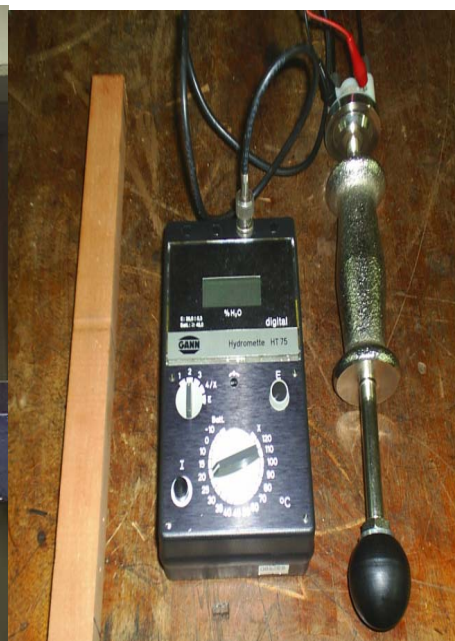
Fig. A.130. Higrómetro para medir el porcentaje de agua en la madera. [76]
