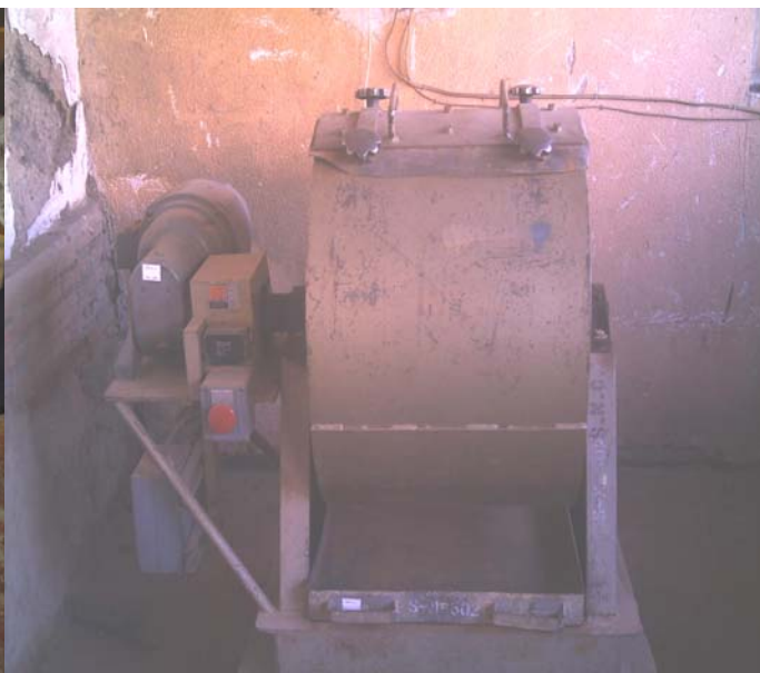
Fig. A.117. Máquina De Los Ángeles. / Lab. ABC. La Paz. Bolivia. Fuente: [Elaboración propia].
