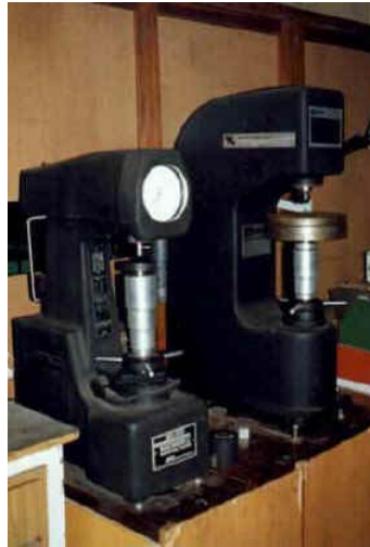
Figura f 10 Durómetro Brinell y Rockwell - Fuente: Laboratorio de la E. E. T.
