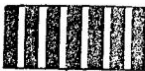
Fig. P 4.8 Abertura de las líneas del estroboscopio cuando el contador está ajustado exactamente a 200 r.p.m.
