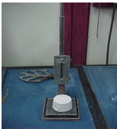
Figura Y8 Aparato de Vicat - Fuente: Elaboración Propia
