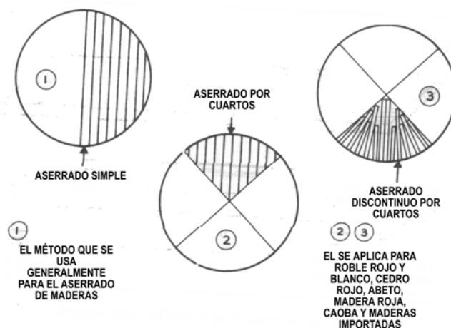
Figura M6 Métodos para aserrado de madera
