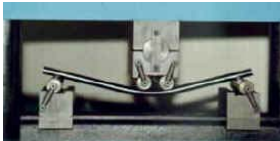
Figura f 9 Probeta sometida a flexión – Fuente: Laboratorio de la E. E. T.
