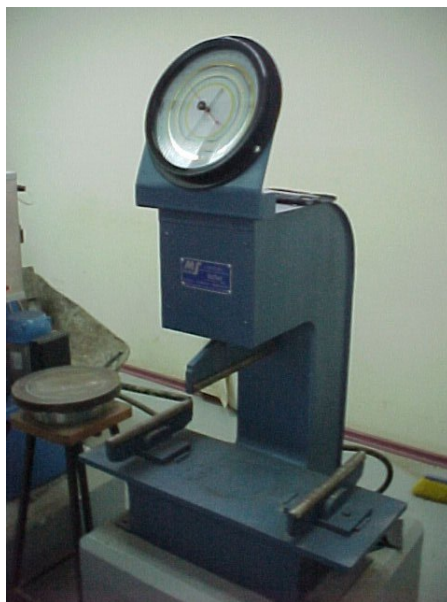
Figura H 6. Equipo para resistencia a la flexión
