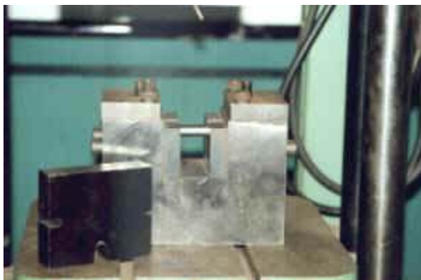
Figura f 12 Dispositivo de ensayo de corte Fuente: Laboratorio de la E. E. T.
