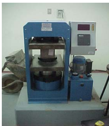
Figura Y13 Maquina para determinar la resistencia a la compresión Fuente: Elaboración Propia
