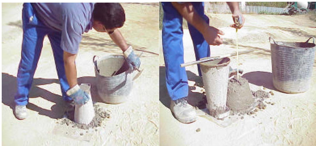
Figura H 2 Ensayo de asentamiento del hormigón
