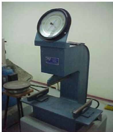
Figura Y12 Maquina de ensayo de flexo tracción - Fuente: Elaboración Propia
