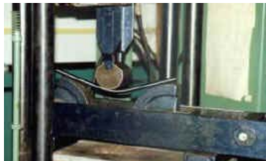
Figura f 11 Probeta sometida a plegado - Fuente: Laboratorio de la E. E. T.
