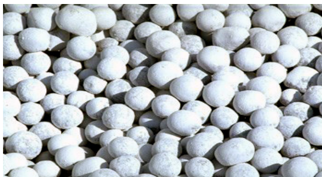
Figura CEM7 Clinker enfriado o cristalizado -
