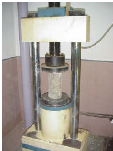
Figura H 5. Máquina de ensayo a compresión de cilindros de hormigón
