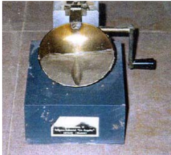
Figura CE 2 Cuchara de Casagrande, utilizada para el ensayo del Límite Líquido
