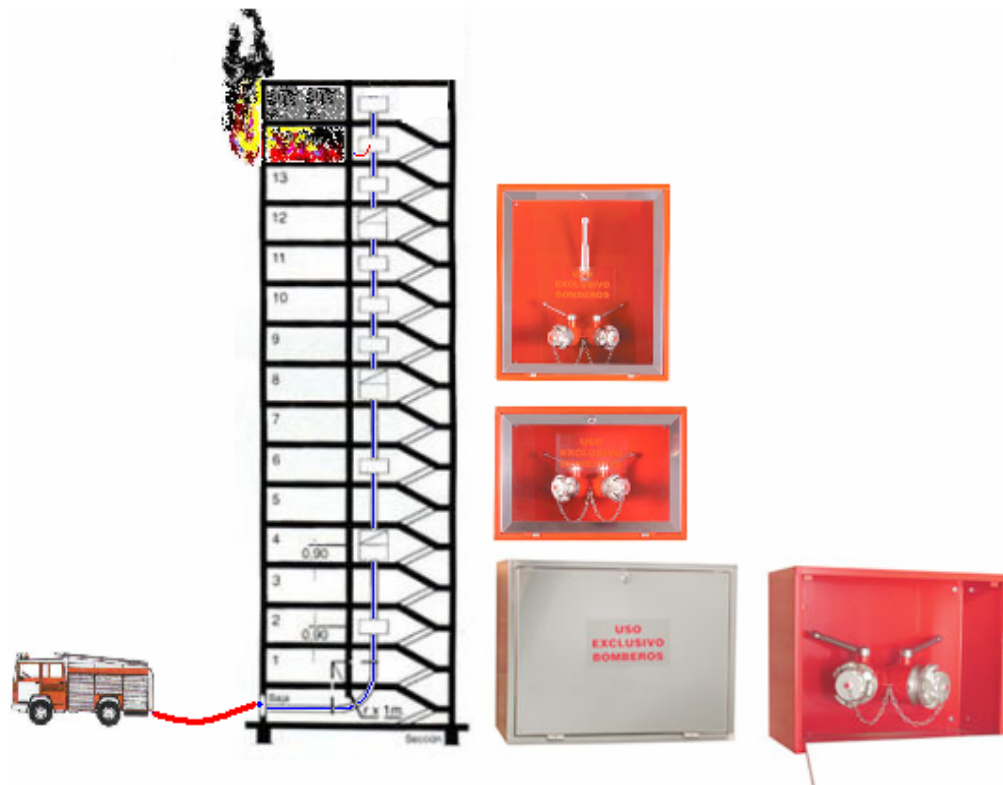
Figura: 6.3 Sistema directo de la conexión a las bocas de incendio
