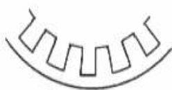
a) Estator de ranuras abiertas
