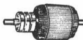
b) Rotor devanado con conductores de cobre en el devanado
