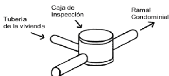
GRAFICA 5.10.- CONEXIÓN DEL RAMAL DENTRO DEL LOTE
